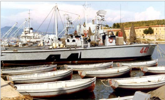
1968: l'ex motosilurante MS 441 , impiegata dagli incursori di Comsubin (dopo essere stata sottoposta a estese modifiche alla parte centro-poppiera dell'unità, con l'imbarco di due "selle" per alloggiare altrettanti mezzi subacquei). Si tratta di una motosilurante statunitense tipo "Higgins" di costruzione bellica, trasferita alla Royal Navy come MTB 422 e ceduta alla Marina italiana ad aprile del 1951. Inizialmente denominata GIS 841 , fu ridenominata MS 441 una volta decaduti i vincoli del trattato di pace che impedivano all'Italia il possesso di motosiluranti, venendo radiata nel 1985 (Coll. M. Brescia)
